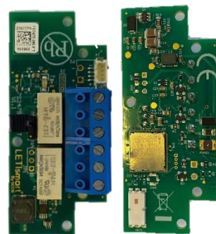
Fig.1 LETismart® TAG SEMAFORO fronte e retro
